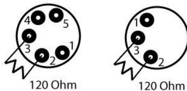
Para conectar más de una unidad, siga el siguiente esquema. La salida de la primera unidad se conecta a la entrada de la siguiente y así sucesivamente, de esta manera es posible enviar la señal a todos los dispositivos de la cadena.
